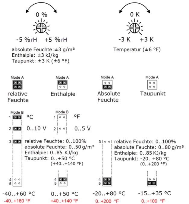
Abb.: (Messbereichs- und Offseteinstellung, Standardeinstellung: -20 °C..+80 °C | 0 K)
